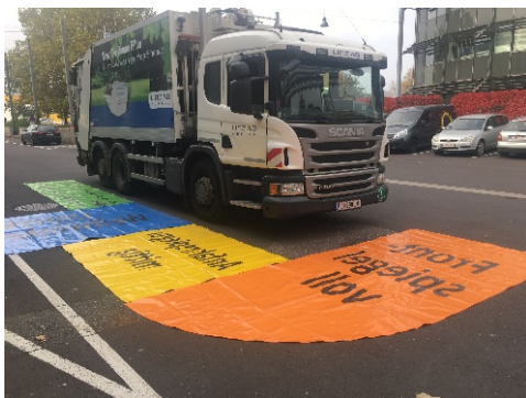
Bildtext: Der Spiegeleinstellteppich zeigt die richtige Spiegeleinstellung beim LKW der Müllentsorgung. Fotonachweis: LINZ AG
