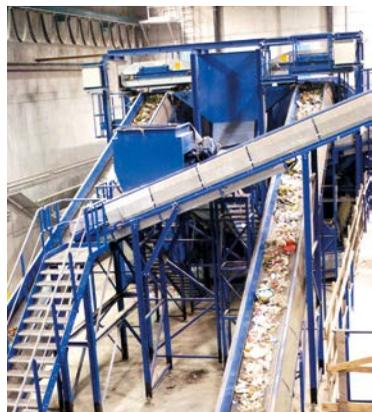
Abtrennung verwertbarer Altstoffe in der Reststoffaufbereitungsanlage (RABA) Linz.
