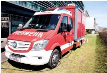
Das vollelektrifizierte Kleinfeuerwehrfahrzeug hat eine Reichweite von etwa 160 km.
