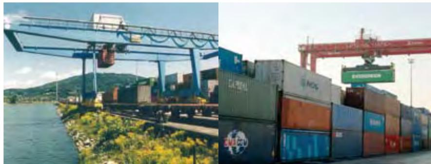
Wandel am Wasser: Die Infrastruktur im Linzer Hafen wird sukzessive dem letzten Stand der Technik angepasst – links der alte und rechts der neue Containerkran (27 m hoch und 152 t schwer).
