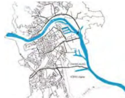
Mit der Zeit wird das Kanalnetz immer dichter und immer länger – im Jahr 1900 ist die Linzer Kanalisation 38 km lang (links), 1950 bereits 170 km (Mitte) und 1975 ganze 375 km (rechts). Heute ist man bei 550 km angelangt.
