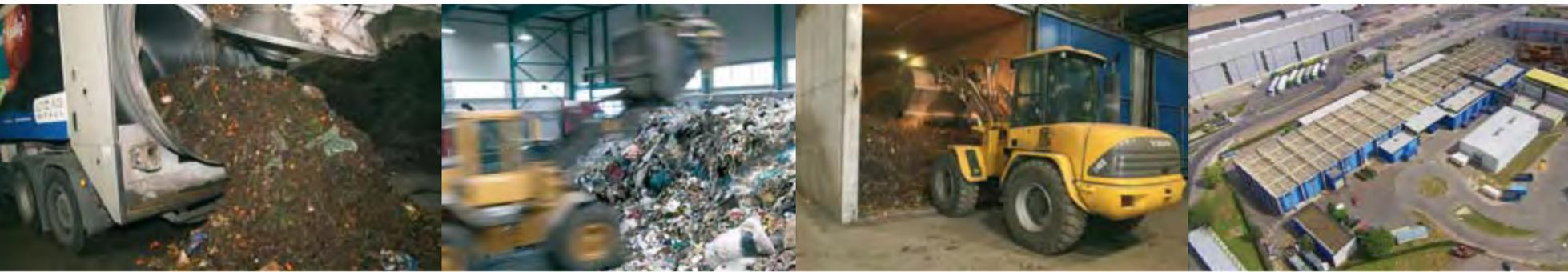
Der gesammelte Restmüll wird in der mechanisch-biologischen Abfallbehandlungsanlage mechanisch und biologisch aufbereitet, stoffspezifisch getrennt und einer weiteren Behandlung und Verwertung zugeführt.
