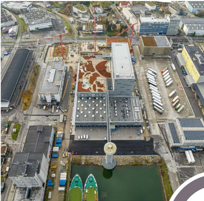
Am Dach der Pharmahalle ist der Unterbau der Parkanlage fertig und das Wegenetz (hell) sowie die Bereiche für Pflanzen (dunkel) bereits grob erkennbar.
