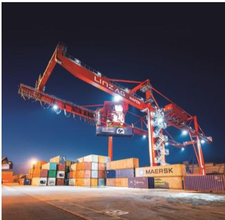
Verlängerung der bestehenden Kranbahn und die Anschaffung eines zweiten Containerportalkrans (RMG = rail mounted gantry crane).
