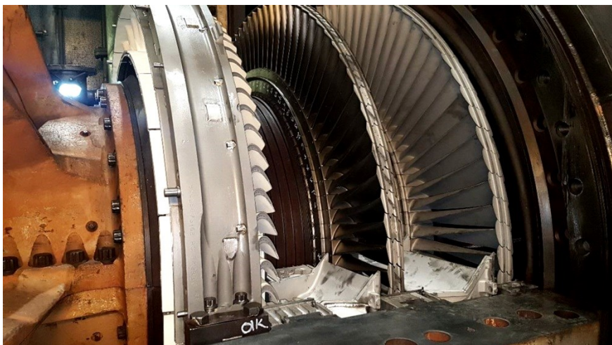
Bildtext: Geöffnete Gasturbine mit Turbi- nenschaufel
