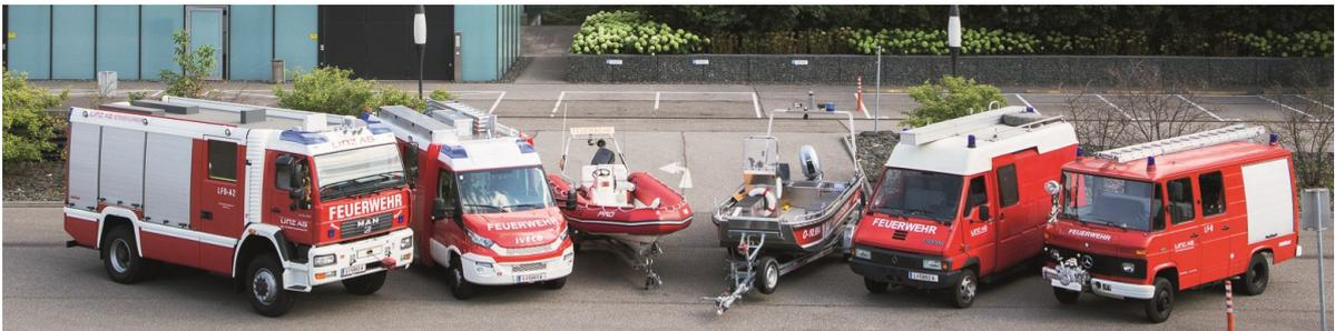
Der Fuhrpark der Betriebsfeuerwehr LINZ AG setzt sich aktuell aus zwei Löschfahrzeugen mit Bergeausrüstung (eines davon mit Allradantrieb), einem Kleinlöschfahrzeug, einem Atemschutzfahrzeug, zwei Tragkraftspritzenanhänger mit Gruppenausrüstung, einem Anhänger mit aufgebautem Wasserwerfer, einem Motorschlauchboot inkl. Anhänger, einem Arbeitsboot inkl. Anhänger und zwei Transportanhängern zusammen.
